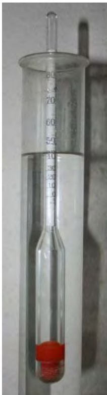
Abbildung 23: Aräometer oder Alkoholmess- spindel
